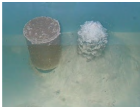
硫酸5%溶液に92日間浸漬した試験体状況
