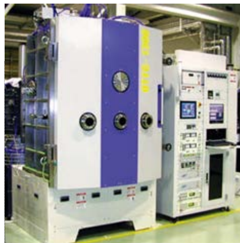
図2. 光学薄膜製造装置(左)と概要図(右)
