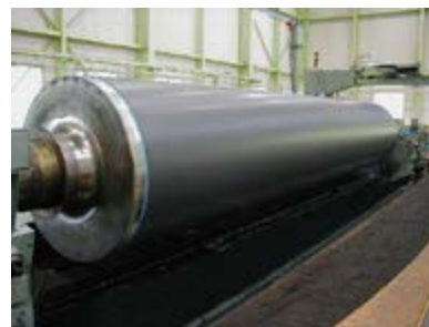
CNCロール研磨機 ・能力 : φ2,000×13,000L ・耐重量 : Max50,000kg
