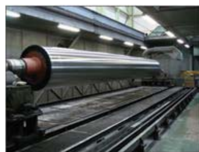
大型ロール溶射装置 ・自社製 ・能力 : φ2,000×13,000L ・耐重量 : Max50,000kg
