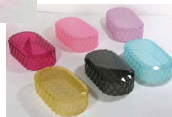
ダイヤカット柄ランチボックスの試作デザイン(光造形による試作品)
