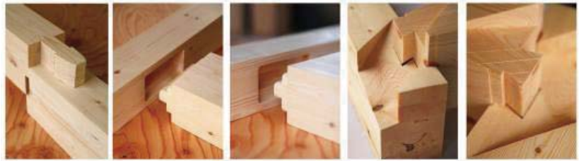
プレカット加工された構造材（継手・仕口）
