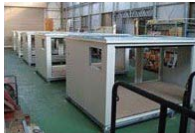
成田第二工場の無線中継シェルター生産ライン
