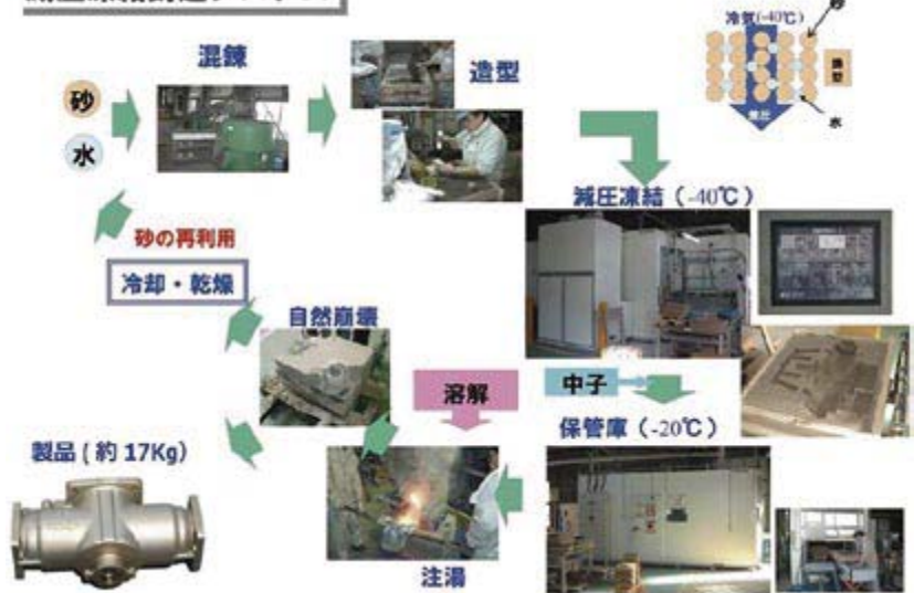
「減圧凍結鋳造システム」
