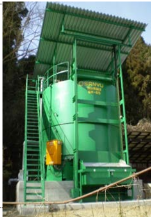
密閉縦型発酵機
