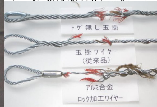
引っ張り試験破断面の比較
