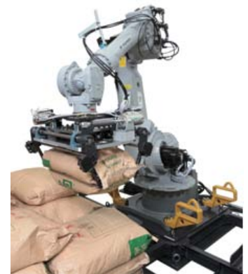
試作開発中の積み下ろしロボット
