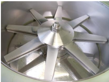
粉碎槽の内部
