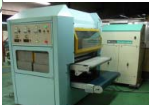
開発した実験機によるバリ取り
