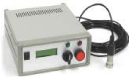
工具破損検出装置
