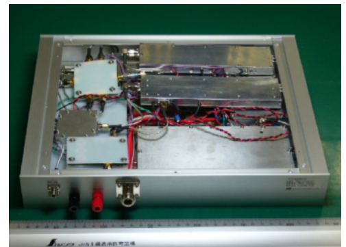
高周波デジタル歪補償器付 高効率低歪増幅部(試作品)
