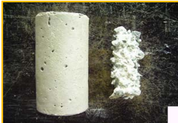
耐硫酸性試験結果 (5%硫酸溶液浸漬30週)
