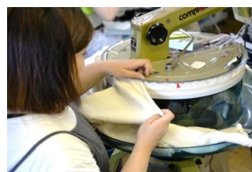
手作業によるリンク加工
