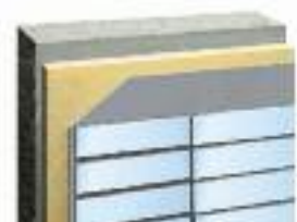
【新外断熱タイル張り工法】
