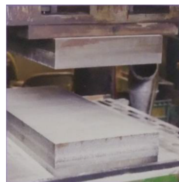
【油圧プレスによる乾式成型】
