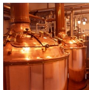
ビール製造設備(糖化釜と煮沸釜)
