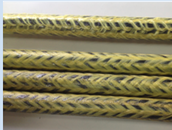
アラミド+炭素繊維組紐強化熱可塑性樹脂パイプ
