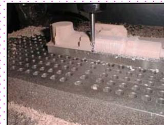
マシニングセンタによるバリ無し木型の製作・鑄仕上げ自動化
