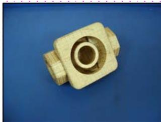
積層造型機による試作の簡素化・迅速化
