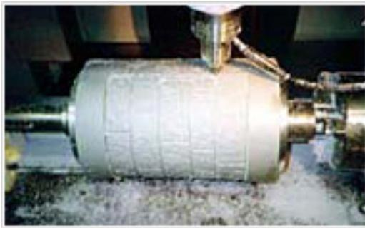
(6) CAMで作成したNCデータを工作機械に転送し加工開始します。加工表面が樹脂ですので高速加工が可能です。
