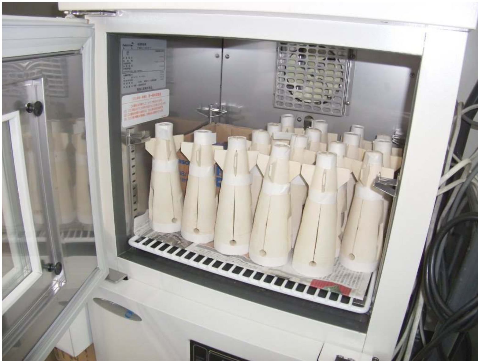
成型後、安生中のモルタル筐体(2010/09/24)
