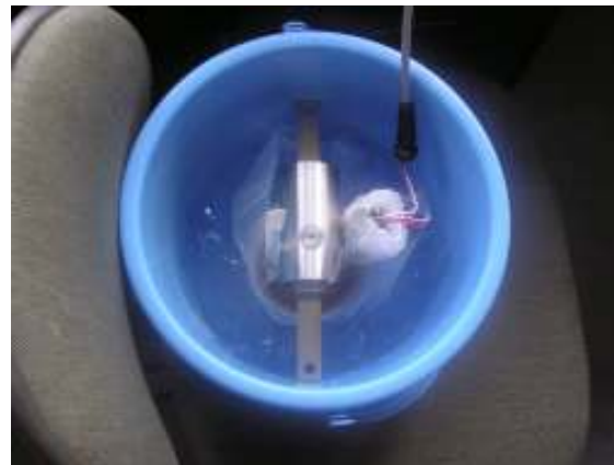
写真6. 計測センサーの実験風景 電子基板の保護樹脂を評価中
