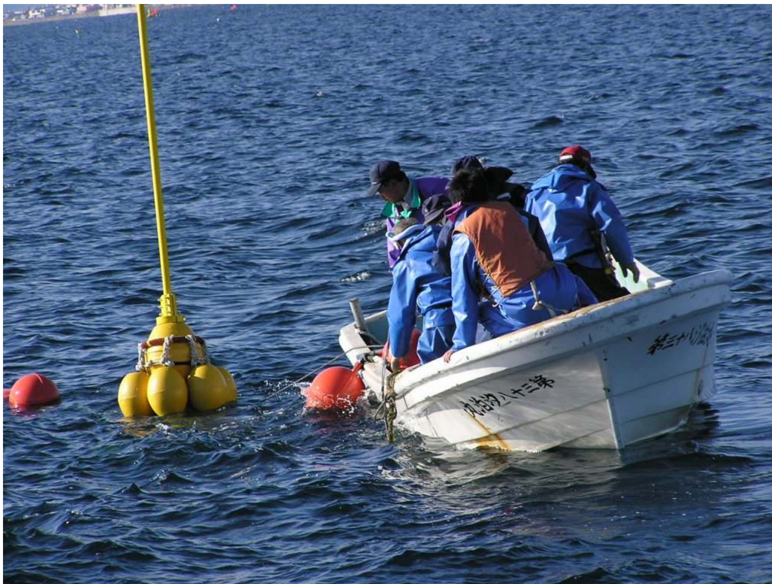
写真11. RASブイ 試作機設置作業 撮影場所：白尻沖
