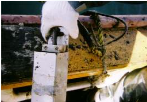
写真5. 実際に取り付けた計測モジュール 保護用のケースをつけた状態
