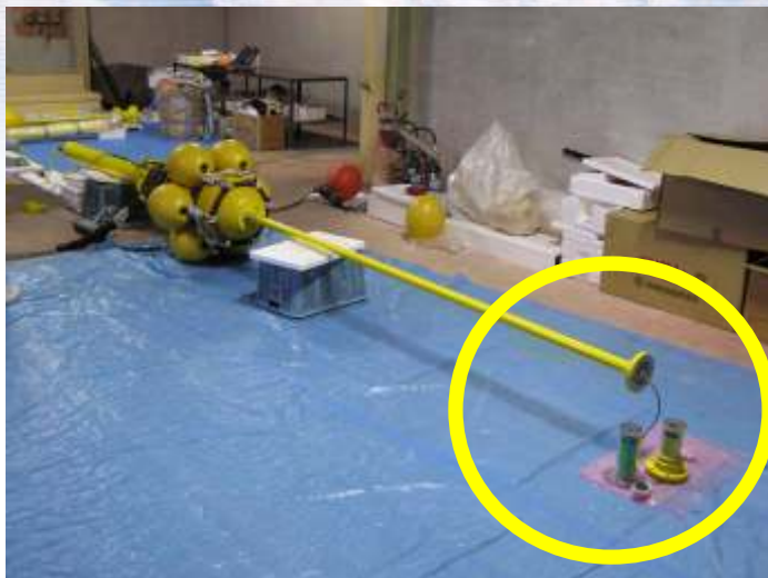
写真1. RASブイ4号機組み立て風景 円内が通信制御ユニット
