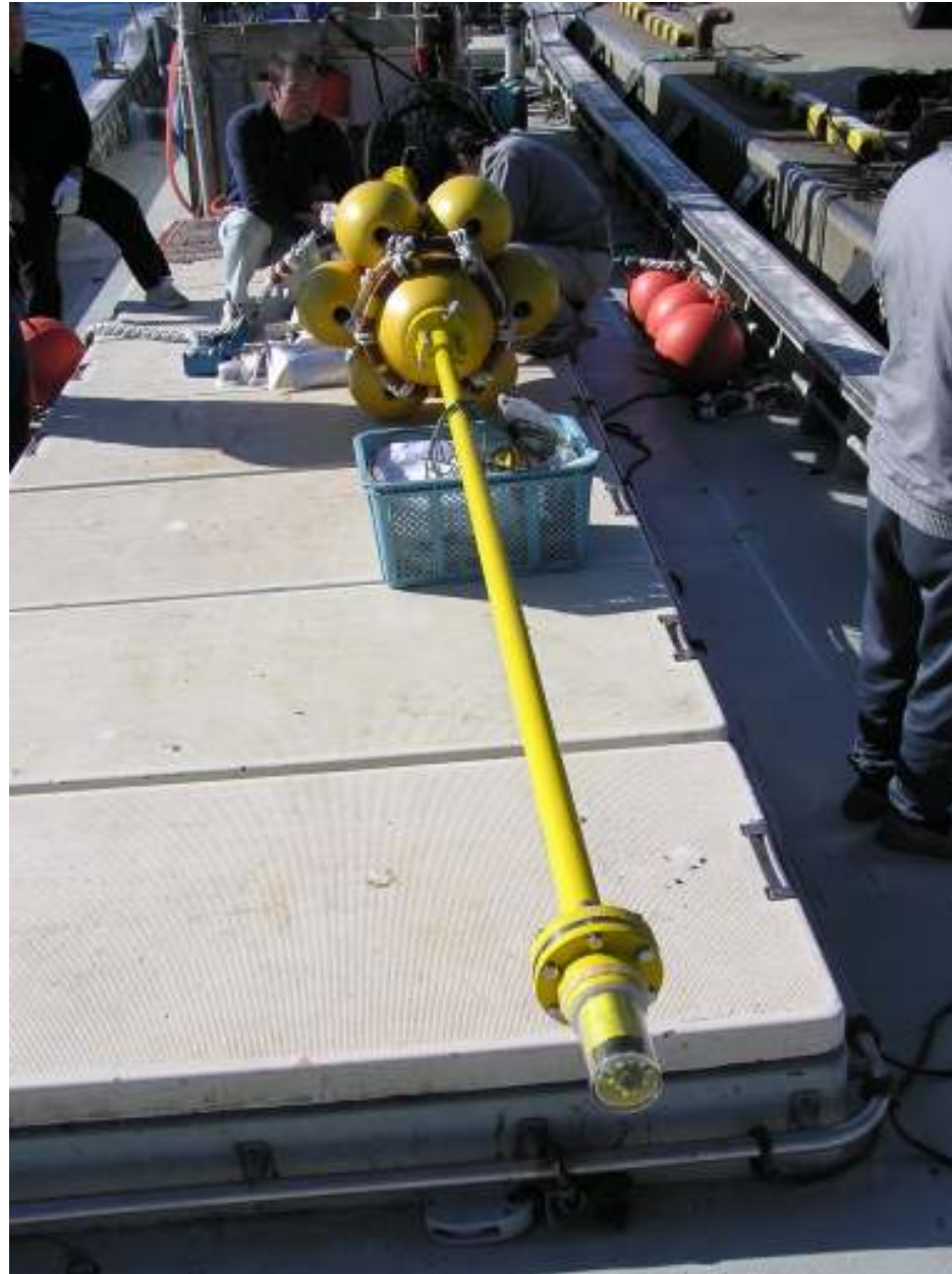
写真8. RASブイ 試作機組立作業 撮影場所： 銭亀漁港
