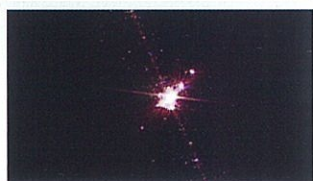
検出した微小欠陥
