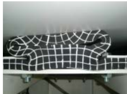
写真-3 バッファ-の限界変形状況
