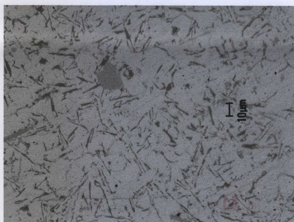
写真2 普通ダイカスト品の金属組織写真 (腐食液は写真1,2とも1wt%NaOH水溶液)
