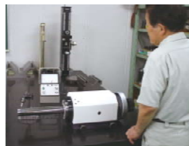
サブミクロンの精度を誇る自社製の静的回転振れ測定器
