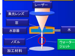
レーザー誘導式ウォーターマイクロジェットのメカニズム
