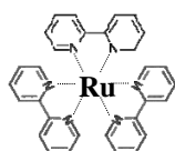
図 8 Ru 錯体 [\text{Ru}(\text{bpy})_3]^{2+} の構造と用途
