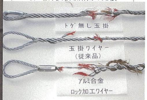
引っ張り試験破断面の比較
