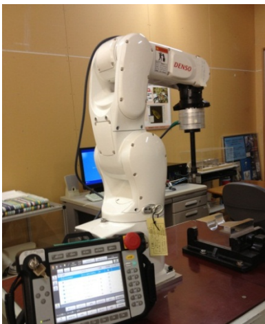
本事業装置: 仕上げ磨きロボット
