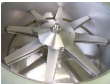
粉碎槽の内部
