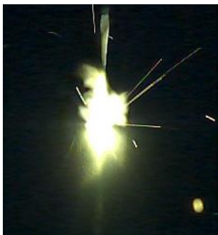
溶接時のプラズマ発生状況
