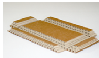
厚い積層段ボールをVカットした箱の蓋の作成例
