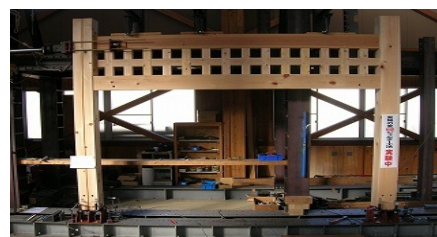
【改良型耐震シェルター工法の欄間】
