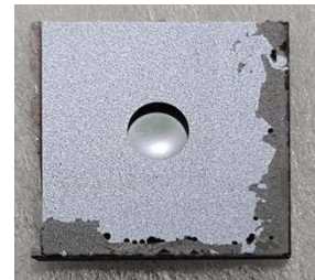
【ダイヤモンド薄膜 試作加工例】 (半導体加工プロセス使用)
