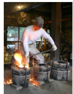
【製造工程 鋳込み】
