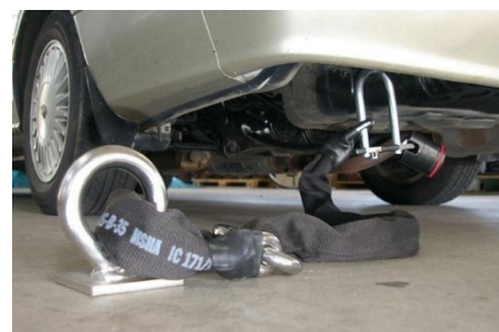
【チェーンの使用例： 地面の取付金具がアンカー。 鎖の先端に車取付け金具を使用】
