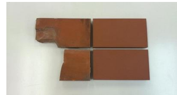
【東京駅に採用された同社タイル (左:既存タイル 右:再現したタイル)】
