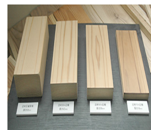
【杉材の圧縮サンプル(左から原板、30%圧縮、50%圧縮、70%圧縮)】
