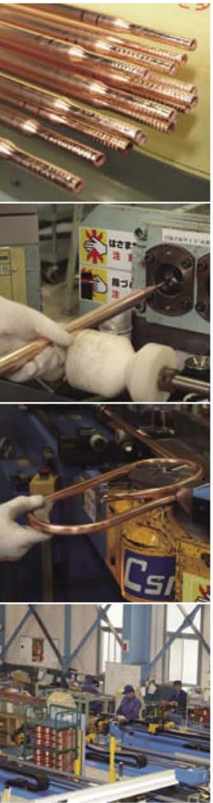
(上)多葉状加工前のパイプ端末絞り (中)管端部を細くするパイプ絞り加工 (下2点)長尺管をレストラット形状に巻き、コンパクトにするパイプ曲げ加工 どこにもない量産化技術をものにするまでにはさまざまな壁が。開発スタートから3年の歳月が過ぎた。パイプ形状に成形するためのダイス設計の工夫や素材を引っ張る力の配分まで、現場の技を総結集。「エコキュート」に採用されたのが2002年。
