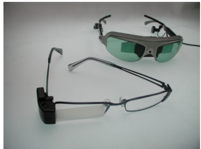
上：ウェアラブルモニター「テレグラス」 下：疲労予防装置付き眼鏡フレーム
