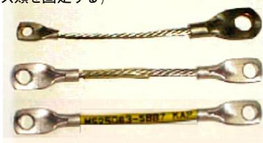
ボンディングジャンパー(機体と電子機器類の電位差をなくす)
