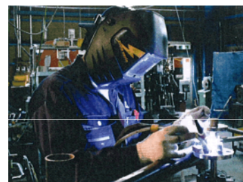
難接材料（チタン材）の溶接
