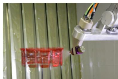
◎円形治具に複数個の被塗物を取り付け治具毎回転させロボットが塗装する「Rの技術」
