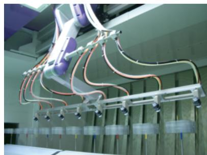
◎1台の天吊りロボットアームに複数ガン装着し高品質、低コストで大量生産を可能にしている
