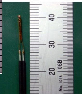
センサー側単線(上)と、多芯線を撚り加工した線(下)とをレーザーにより接合
