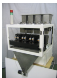
4種混合PS-10P2×4 秤量範囲:0.1g~20.g 生産能力:40回/分 同時計量品種数:4
