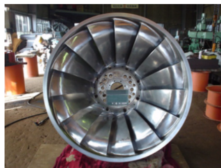
図2 特殊低温肉盛溶接および機械加工によって、新品と同等にリニューアルした発電用水車ランナ(修繕後の状態)
