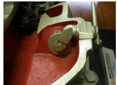
ウェストゲートバルブ取付け状況
